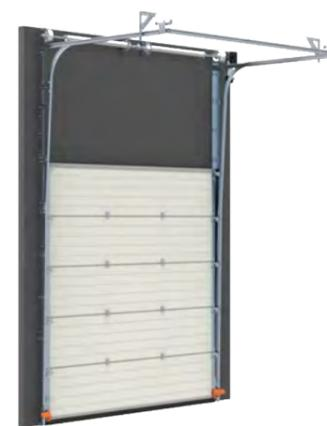
Die Laufschienen sind auf einen hohen Sturzbereich abgestimmt. Die Variante führt zwei Öffnungsbewegungen aus: Beim ersten Abschnitt öffnet das Tor senkrecht, im zweiten Abschnitt waagrecht.
