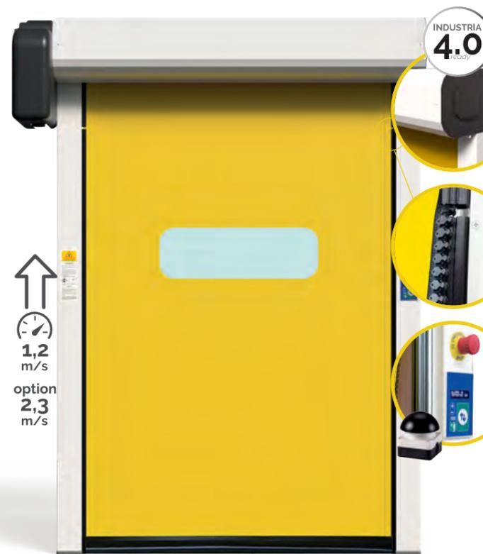
**DIE ZIP-SCHNELLAUFTORE** sind die flexibelsten Produkte der Active Modellen. Das mit aus PVC-Reißverschluss ausgestatteten Torbehang läuft durch einschmierende Laufschiene aus Polyethylen hierdurch wird der Behang über die gesamte Torhöhe verbunden, das ermöglicht, die Beständigkeit vom Tor gegen eindringenden von Wasser und Winddichtheit (Klasse 3) zu gewährleisten. Die ZIP-Türen sind bis zu einer Breite von 4000 mm selbstreparierend.
