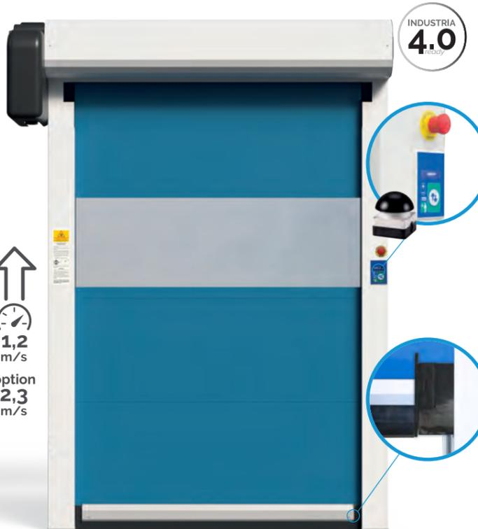
**DIE GLIDE SCHNELLLAUFTORE** eignen sich für den Einsatz in Supermärkten und Geschäften, da sie geräuschlos und wartungsfreundlich sind. Im Torbehang sind Verstärkungen vorgesehen, bei einem Crash wird die aus Aluminium Bodenschiene aus den PVC-Führungsschienen gedrückt. Anschließend wird der Behang automatisch wieder eingefädelt und das Tor kann weiter betrieben werden.
