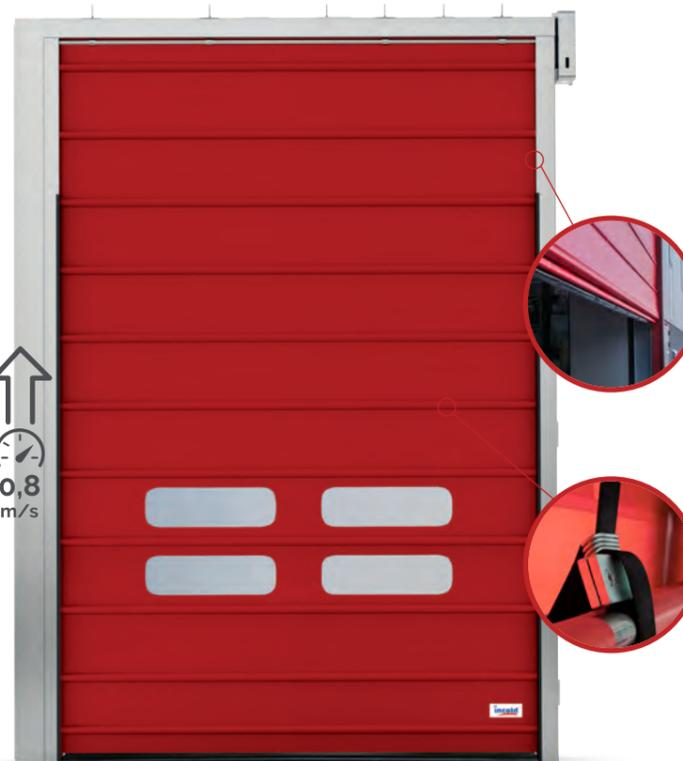
**DIE FOLD FALTSCHNELLLAUFTORE** sind strapazierfähig dank des gefalteten Rahmens aus 3 mm starkem verzinktem Stahlblech. Das Faltsystem besteht aus einem Behang (PVC-beschichtet), welches über die gesamte Breite mit verzinkte Stahlrohre verstärkt ist, diese sind in eingeschweißten Taschen verstaute. Der Durchmesser der Verstärkungsrohre variiert je nach geforderter Luftdruckwiderstandsklasse. Das Öffnen des Tores erfolgt über ein Gurtsystem, der oberhalb der Wickelwelle positioniert ist.
