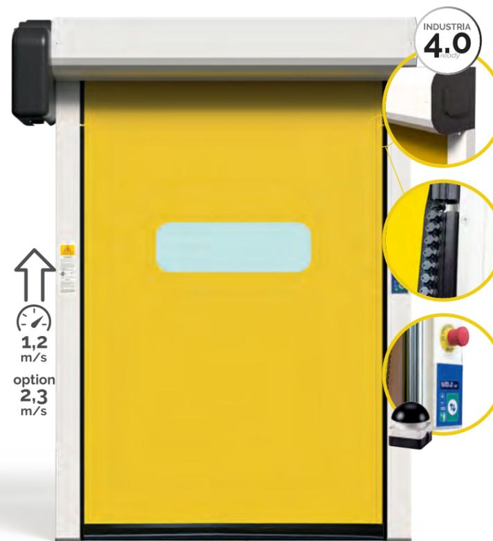
**LES PORTES À ENROULEMENT RAPIDE ZIP** sont les plus versatiles de la gamme Active. Le tablier est équipé de charnières en PVC qui glissent sur des glissières en polyéthylène autolubrifiants et relient le tablier sur toute la hauteur de la porte, assurant ainsi son étanchéité et sa résistance au vent (classe 3). Les portes ZIP sont autoréparantes jusqu'à une largeur de 4000 mm.
