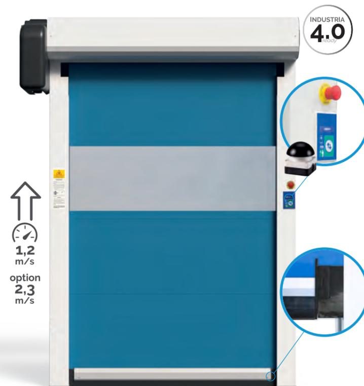
**LES PORTES À ENROULEMENT RAPIDE GLIDE** conçues pour les supermarchés et pour les magasins de détail, sont silencieuses et nécessitent peu d'entretien. Ils se composent d'un tablier avec renforcements longitudinaux et d'une barre inférieure en alliage d'aluminium qui coulisse librement dans les glissières. La barre inférieure rentre automatiquement dans les glissières en cas d'impact accidentel.
