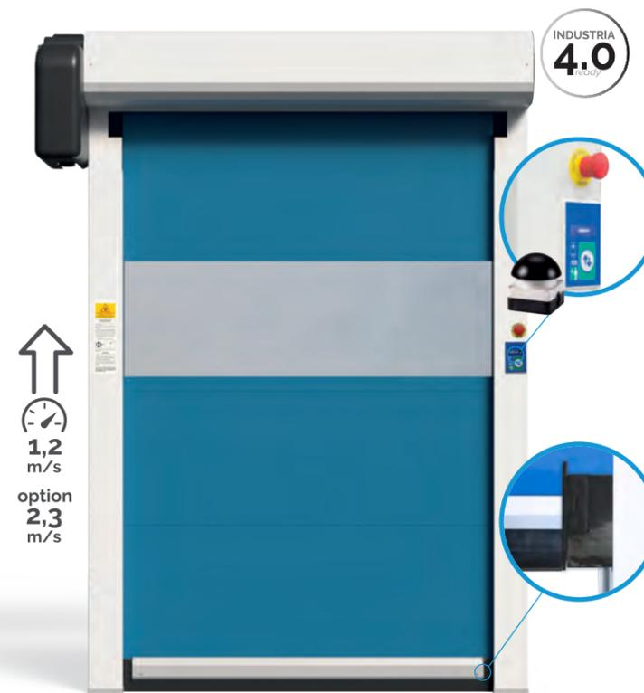
**LE PORTE AD AVVOLGIMENTO RAPIDO GLIDE** sono adatte alle applicazioni in supermercati e punti vendita, sono silenziose e necessitano di poca manutenzione. Sono costituite da manto staccato e barra inferiore in lega di alluminio a scorrimento libero nelle guide. La barra inferiore rientra nelle guide in caso di urto accidentale.
