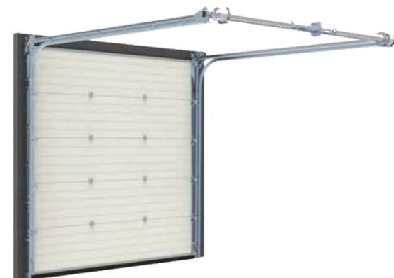
La curva delle guide ha una raggatura che permette di aprire il portone anche con architravi molto bassi (200, 250, 320 mm).
