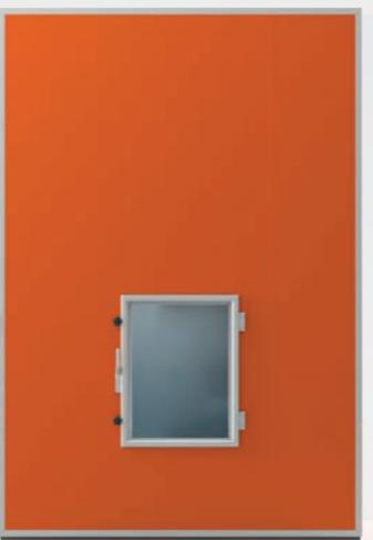
**Battente** costituito da un sandwich monolitico in lamiera preverniciata di colore arancio puro RAL 2004, contornato da un profilo in acciaio inox AISI 304, isolato con PUR densità 40 Kg/m<sup>3</sup>, lungo il cui perimetro è alloggiata la guarnizione di tenuta al gas, lo spessore standard è di cm 12.
