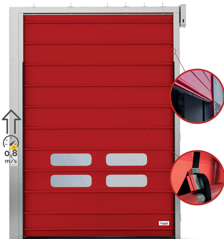
**LE PORTE AD IMPACCHETTAMENTO FOLD** sono robuste grazie al telaio piegato in lamiera di acciaio zincato spessore 3mm. Il sistema di impacchettamento è costituito da un telo (in tessuto spalmato PVC), rinforzato internamente da tubi in acciaio zincato posti all'interno di tasche saldate. Il diametro dei tubi di rinforzo varia a seconda della classe di resistenza alla pressione dell'aria richiesta. L'assieme telo è sollevato grazie a cinghie fissate sopra all'albero di avvolgimento.
