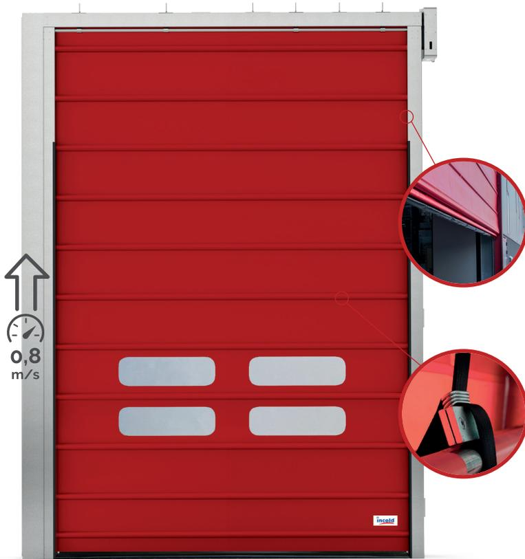
**DIE FOLD FALTSCHNELLLAUFTORE** sind strapazierfähig dank des gefalteten Rahmens aus 3 mm starkem verzinktem Stahlblech. Das Faltsystem besteht aus einem Behang (PVC-beschichtet), welches über die gesamte Breite mit verzinkte Stahlrohre verstärkt ist, diese sind in eingeschweißten Taschen verstaute.
