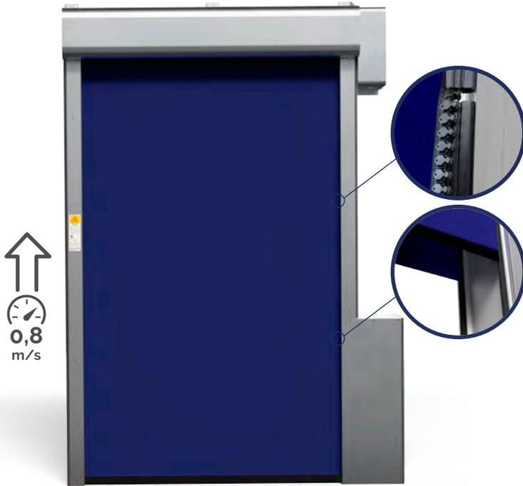
**LE PORTE AD AVVOLGIMENTO RAPIDO FREEZER 2** con doppio telo da 900 g/m<sup>2</sup> e cuscinetto d'aria garantiscono un'elevata separazione termica tra interno ed esterno. Sono caratterizzate da cerniere laterali in PVC che scorrono su guide verticali autolubrificanti.
