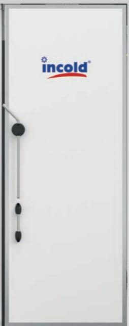
**Battente** costituito da un pannello sandwich in lamiera preverniciata RAL 9010 isolato con PUR densità 41 KG/m<sup>3</sup> ± 10 %, cornice perimetrale in alluminio anodizzato, lungo il cui perimetro è alloggiata la guarnizione di tenuta. Spessore 92 mm (solo per versione TN) e spessore 121 mm.
