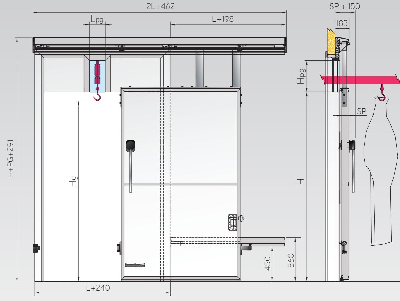
**Fissaggio** - Fixing - Fixation - Befestigung**Fissaggio con telaio interno**
