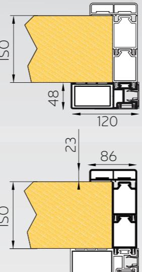
**Telaio** in materiale plastico di colore bianco rinforzato internamente in acciaio.
