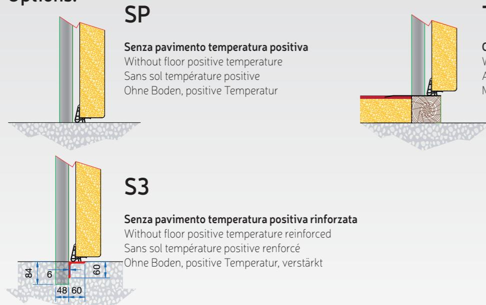
**Finitura battente** - Leaf finishing - Finition vantail - Türblattausführung:
