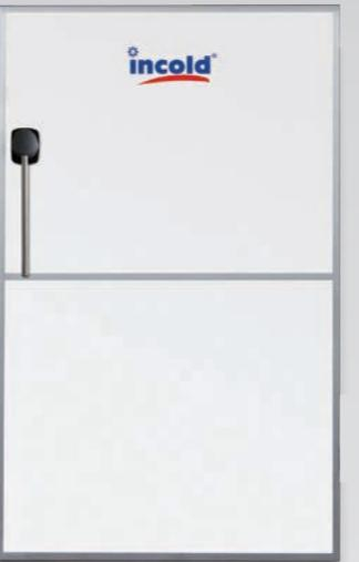
**Battente** costituito da un pannello sandwich in lamiera preverniciata RAL 9010 isolato con PUR densità 41 KG/m<sup>3</sup>, cornice perimetrale in alluminio anodizzato, lungo il cui perimetro è alloggiata la guarnizione di tenuta. Unico spessore 9 cm.
