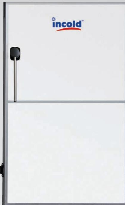
**Battente** standard costituito da un pannello sandwich in lamiera preverniciata RAL 9010 isolato con PUR densità 41 KG/m<sup>3</sup>, cornice perimetrale in alluminio anodizzato, lungo il cui perimetro è alloggiata la guarnizione di tenuta. Spessori disponibili: cm 7 (mod.SC07) e cm 9 (mod.SC09) per porte TN, per le versioni in bassa temperatura lo spessore standard è di cm 12 (mod.SC12).
