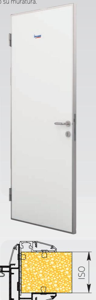
**Battente** spessore 4 cm costituito da due supporti in lamiera preverniciata colore bianco Ral 9010 con interposta schiuma poliuretanica iniettata ad alta densità. La ferramenta è costituita da 2 cerniere in alluminio anodizzato con cardini autolubrificanti, maniglia ergonomica in acciaio inox, serratura con cilindro europeo sistema Master Key.
