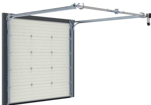
La curva delle guide ha una raggiatura che permette di aprire il portone anche con architravi molto bassi (200, 250, 320 mm).
