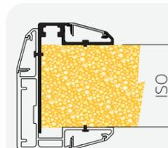
**Controtelaio** in alluminio anodizzato con sistema di fissaggio a scomparsa (non fornito per applicazioni su muratura).
