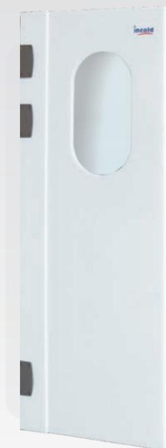
**Battente** costituito da una lastra in polietilene ad alta densità di spessore 1,5 centimetri; rinforzata sul lato cerniere con un montante spessore 4 centimetri dello stesso materiale; sui 2 bordi verticali sono previste delle strisce in PVC morbido trasparente per evitare lo schiacciamento delle dita. L'Oblò trasparente è di misura 30 x 60 centimetri. La ferramenta è costituita da 3 cerniere in materiale plastico con molla di ritorno e fermo porta a 90°.
