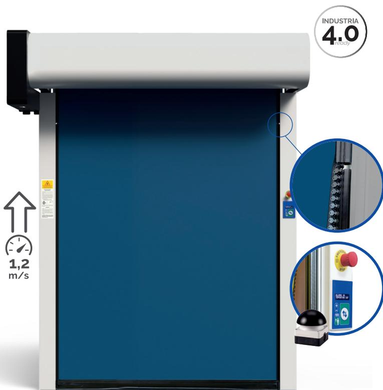
**LE PORTE AD AVVOLGIMENTO RAPIDO ZIP ISO 7** sono caratterizzate da un alto isolamento termico grazie al telo coibentato ISO 7 spessore 7 mm. Il manto è con cerniere in PVC che scorrono su guide autolubrificate in polietilene, e connettono il telo per tutta l'altezza della porta. Le porte ZIP ISO 7 sono autoriparanti fino ad una larghezza di 4000 mm. **Kit isolamento: guarnizione, taglio termico e guarnizioni dietro ai montanti di serie**
