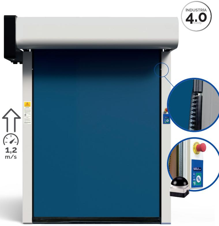
**DIE ZIP ISO 7-SCHNELLAUFTORE** zeichnen sich dank der 7 mm dicken ISO 7-Isolierplane aus durch eine hohe Wärmedämmung aus. Der Vorhang ist mit PVC-Reißverschlüssen ausgestattet, die auf selbstschmierenden Polyethylen-Führungen gleiten und die Plane mit der gesamten Höhe des Tores verbinden. Die ZIP ISO 7-Türen sind bis zu einer Breite von 4000 mm selbstreparierend.
