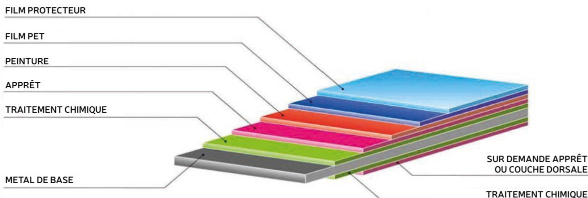
**Support métallique standard:** Tôle en acier au carbone galvanisé à chaud système Sendzmir, type S250GD + Z 100 selon EN 10346:2009.
