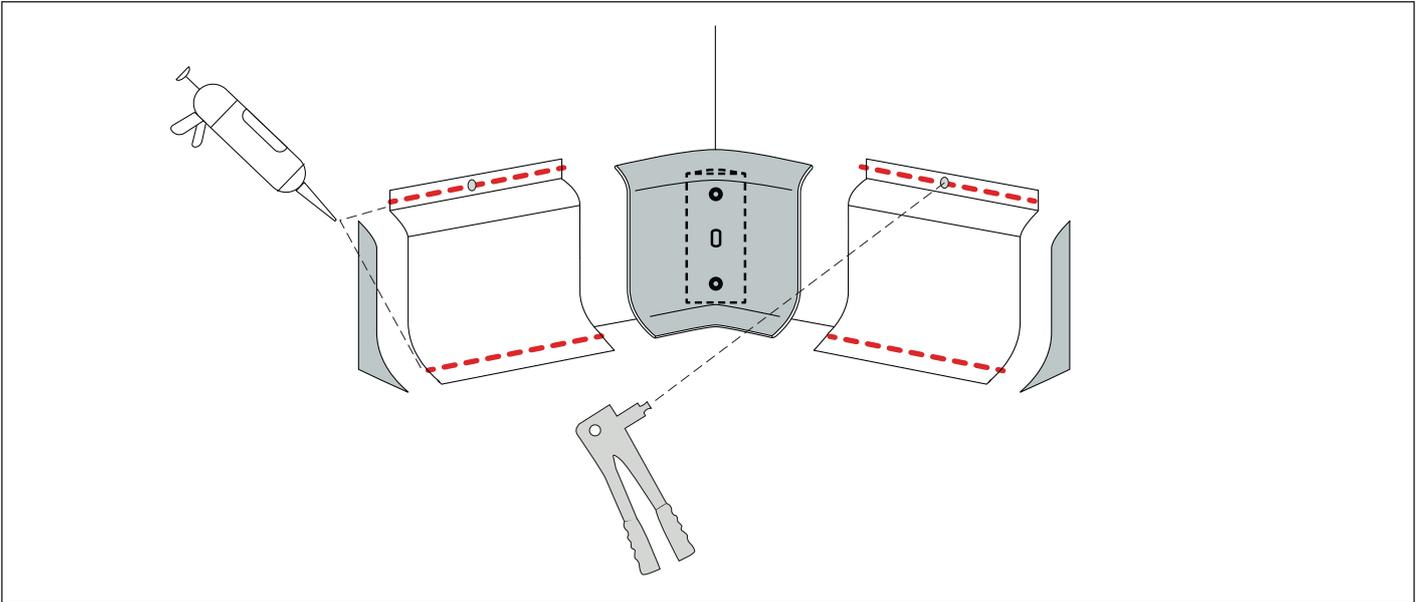
1. Befestigen Sie an der Ecke die geschlossene Eckhalterung 02400003 mit NR° 2 selbstbohrenden Schrauben 04854004;
