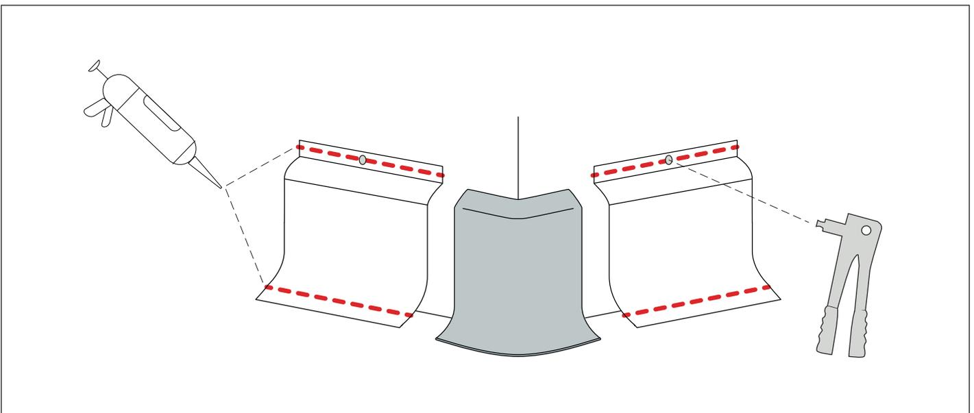
1. Bringen Sie die Edelstahlsockelleiste an der Wand an, entlang der Kanten zwischen Boden und Wand;
