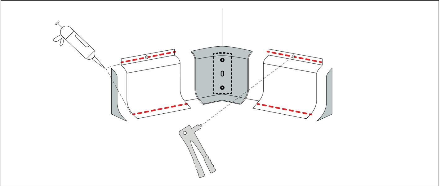
1. Fissare sullo spigolo il supporto per angolo chiuso 02400003 con n°2 viti autoperforanti 04854004;
