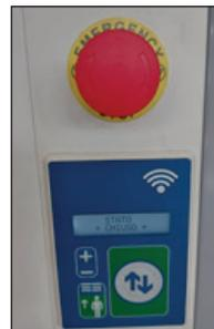
Sie wird gut sichtbar am Torträger befestigt, um sicherzustellen, dass das Tor im Bedarfsfall sofort anhält. Die Not-Aus-Taste ist in allen Betriebsarten der Maschine sofort zugänglich und verfügbar. Die Taste, die als Notauschalter dient, ist pilzförmig (d. h. wird mit der Handfläche betätigt). Die Kontakte wechseln den Zustand, sobald die Taste in der gedrückten Position eingerastet ist.
