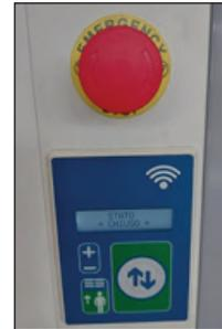
E' fissato sul montante della porta in maniera ben visibile, per garantire l'arresto immediato della porta qualora ce ne fosse bisogno. Il pulsante di arresto di emergenza è immediatamente accessibile e disponibile in tutte le modalità di funzionamento della macchina. Il pulsante utilizzato come dispositivo di arresto di emergenza è a fungo (o azionabile con il palmo della mano). I contatti cambiano stato non appena il pulsante si blocca in posizione premuta.
