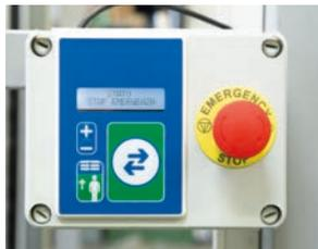
Quadro elettrico con tastiera e pulsante emergenza, da fissare solo in ambienti a temperatura positiva (> 0°C). Se la porta Roll Up Freezer è installata all'interno della cella freezer, il quadro elettrico deve essere installato sul lato opposto (lato positivo), poi attraverso un foro passeranno all'interno i cavi elettrici e le sonde per il controllo dell'automazione.
