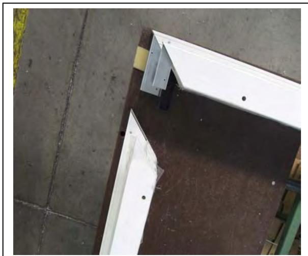
**Illustration 15:** Détail de l'angle gauche du cadre avant l'assemblage
