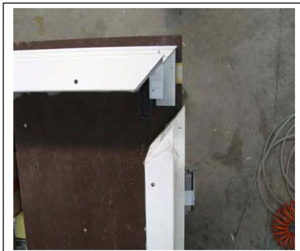
**Illustration 16:** Détail de l'angle droite du cadre avant l'assemblage
