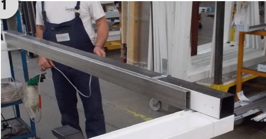
Fixer le seuil inférieur en acier tubulaire sur le cadre de la porte
