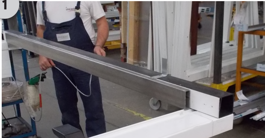
Fissare la soglia inferiore in tubolare al telaio della porta
