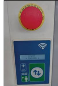
Sie wird gut sichtbar am Torträger befestigt, um sicherzustellen, dass das Tor im Bedarfsfall sofort anhält. Die Not-Aus-Taste ist in allen Betriebsarten der Maschine sofort zugänglich und verfügbar. Die Taste, die als Notausschalter dient, ist pilzförmig (d. h. wird mit der Handfläche betätigt). Die Kontakte wechseln den Zustand, sobald die Taste in der gedrückten Position eingerastet ist.
